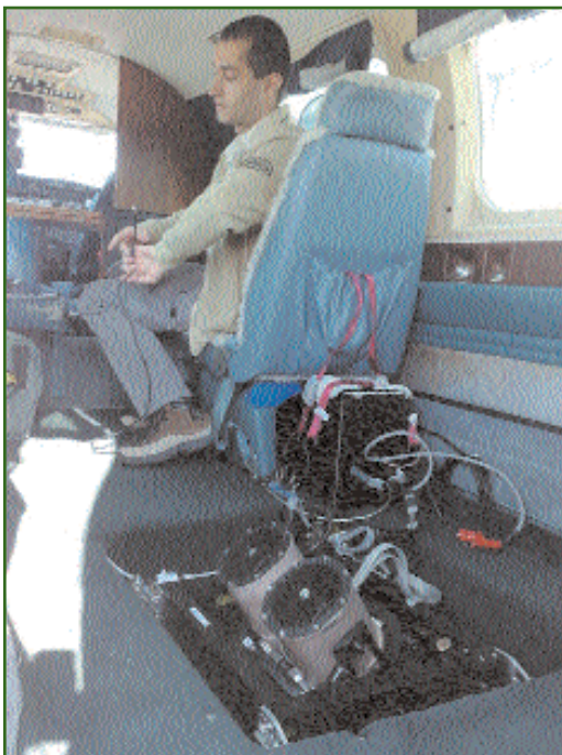
Рис. 2 АФК VisionMap A3 на борту самолета
