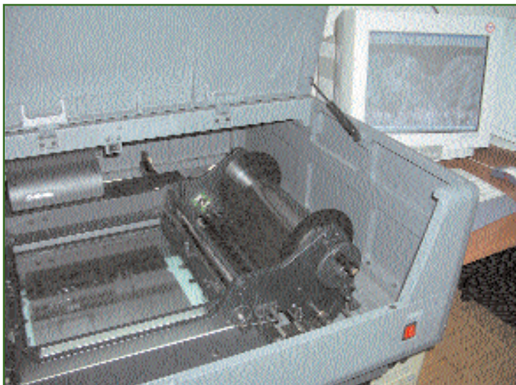
Рис. 1 Высокоточный фотограмметрический сканер с автоматической подачей пленки
