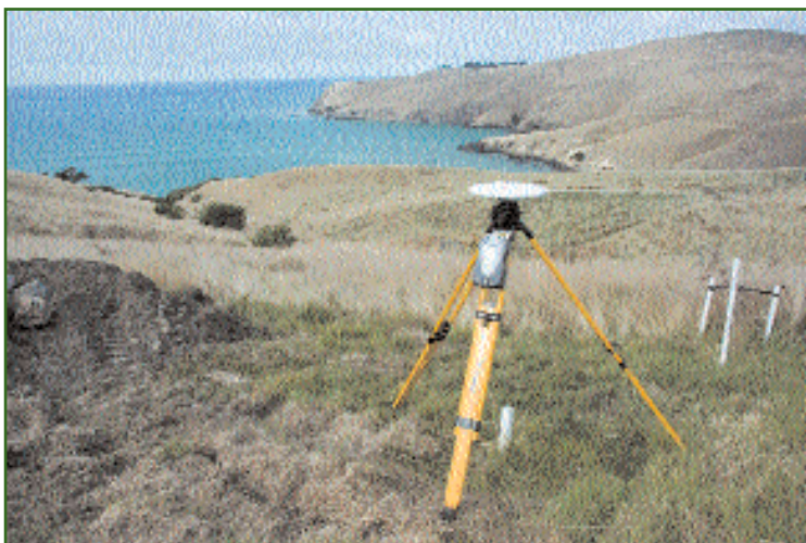
Рис. 4 Спутниковый приемник Trimble R7 GNSS в качестве полевой базовой станции
